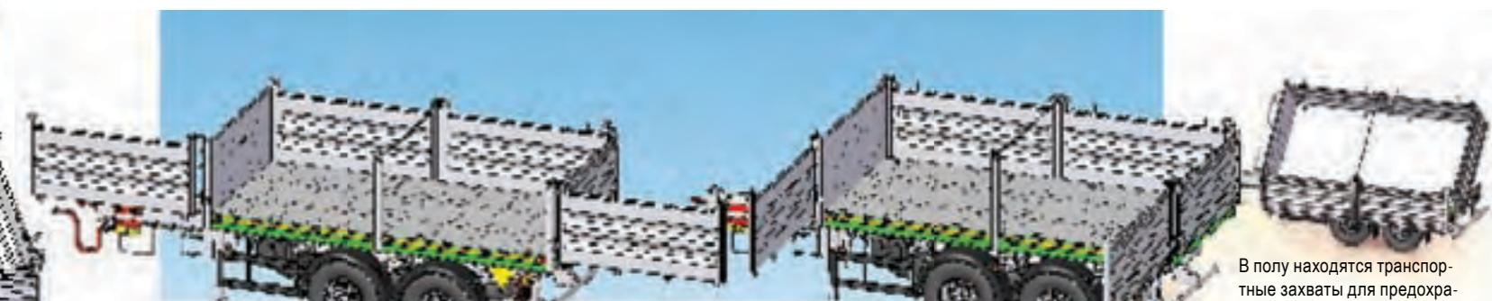
Трехсторонняя разгрузка, внутренний размер по ширине паллет и открываемые борта – все это значительно повышает функциональность и универсальность платформы
