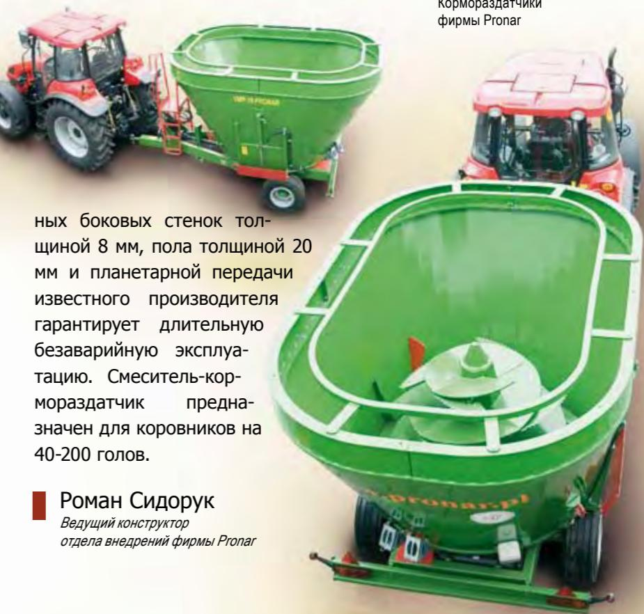
ных боковых стенок толщиной 8 мм, пола толщиной 20 мм и планетарной передачи известного производителя гарантирует длительную безаварийную эксплуатацию. Смеситель-кормораздатчик предназначен для коровников на 40-200 голов.
