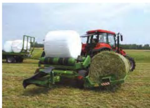
Навесной обмотчик рулонов Z235 оснащен механизмом выгрузки рулона и обрезки пленки
