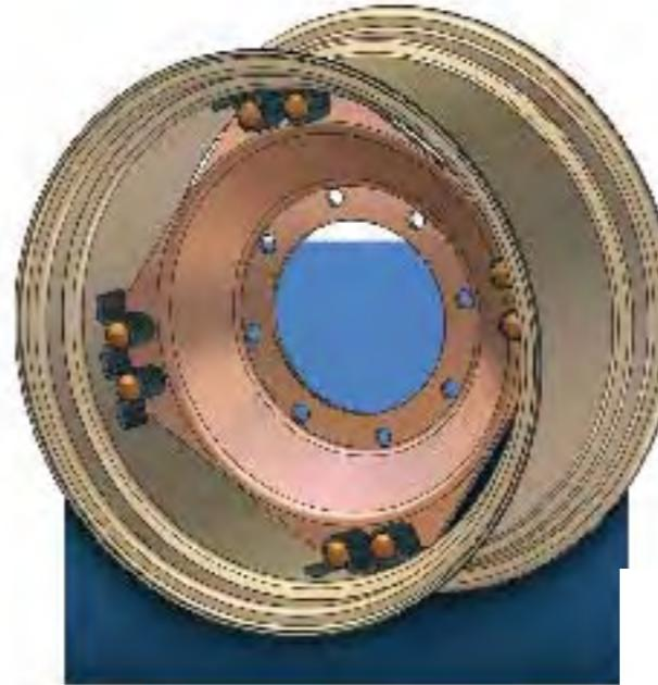
Трехмерная заготовка колеса, производимого на фирме Pronar. Надежность колеса подтверждают, что колесо отличается надлежащей усталостной прочностью, можно приступать к запуску серийного производства.
