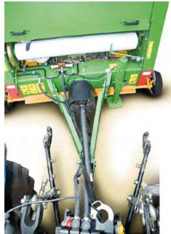
Присоединение закаточного пресс-подборщика Z 500 к трактору при помощи широкоугольного карданного телескопического вала с предохранительной муфтой
