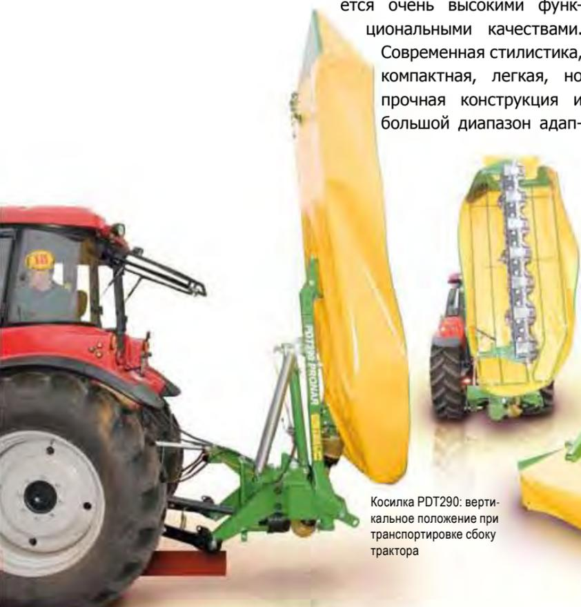
Косилка PDT290: вертикальное положение при транспортировке сбоку трактора
