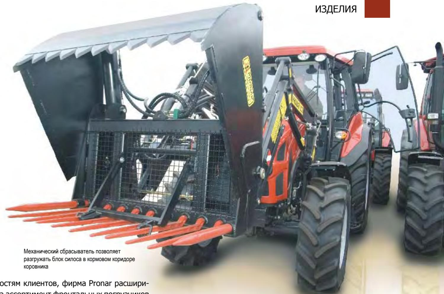
Механический сбрасыватель позволяет разгружать блок силоса в кормовом коридоре коровника
