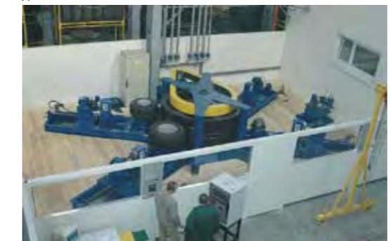
Испытательная лаборатория - испытание колеса на радиальную нагрузку
