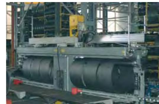
Установка для плазменной сварки колец
