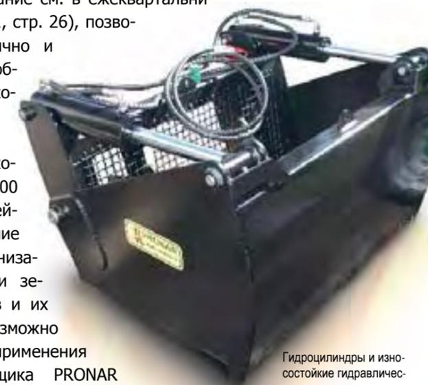
Гидроцилиндры и износостойкие гидравлические провода гарантируют безопасную вырезку силоса из призмы
