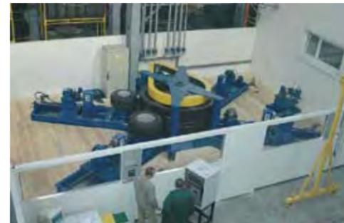
Исследовательская лаборатория - испытание колеса на радиальную нагрузку
