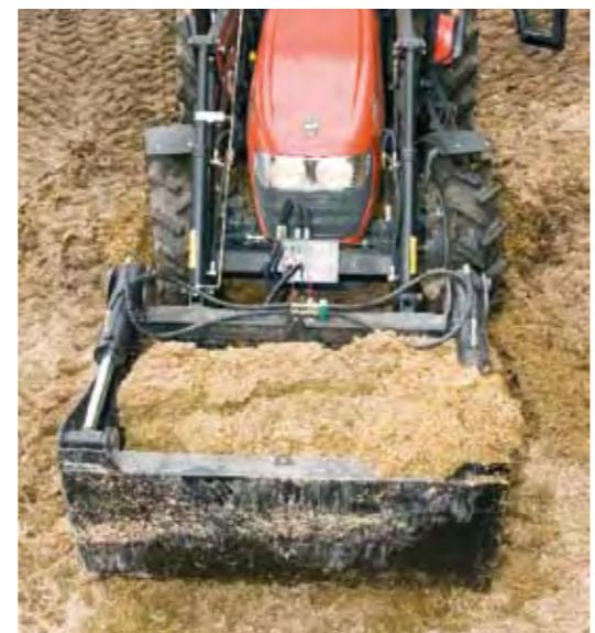
При помощи резчика силоса, работающего вместе с фронтальным погрузчиком, можно также перевозить корм к месту кормежки
