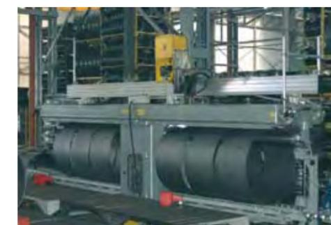
Установка для плазменной сварки колец
