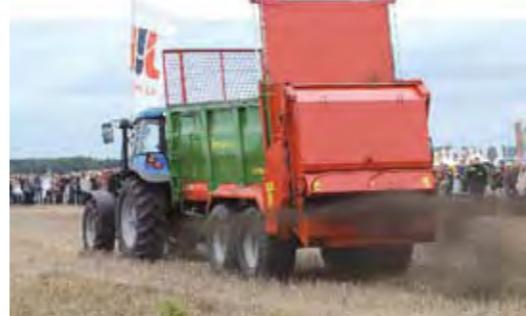
Разбрасыватель удобрений HERKULES N262 грузоподъемностью 12 тонн в действии. Участникам показа рекомендуем отойти на несколько шагов назад – ширина разброса составляет 25 метров (конечно же, с возможностью регулирования)
