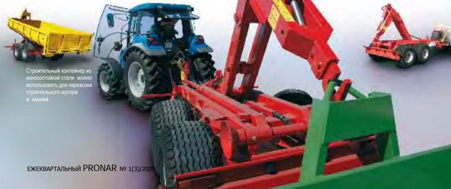
Наклоняемые рамы прицепа облегчают оператору зацепление крюка и отсоединение контейнера
