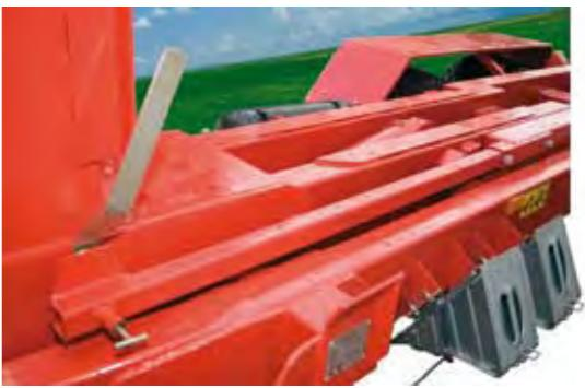
Рычаг управления рамами прицепа в промежутке между закреплением/отсоединением и опрокидыванием контейнера
