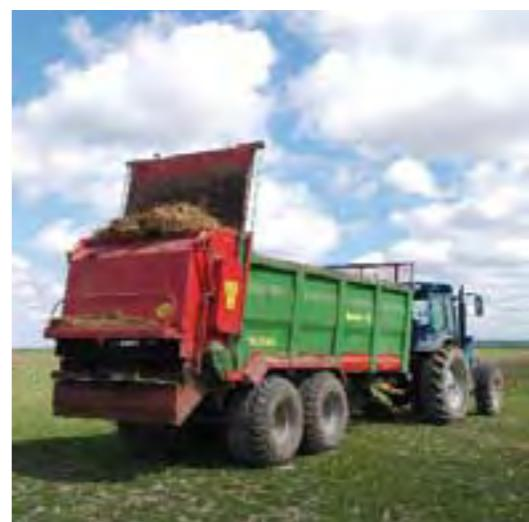
Одновременное испытание прицепа на тридем-шасси T780 и трактора модели PRONAR 8140 с трехточечной задней навеской: боковой наклон на 45 градусов, а через минуту опрокидывание назад
