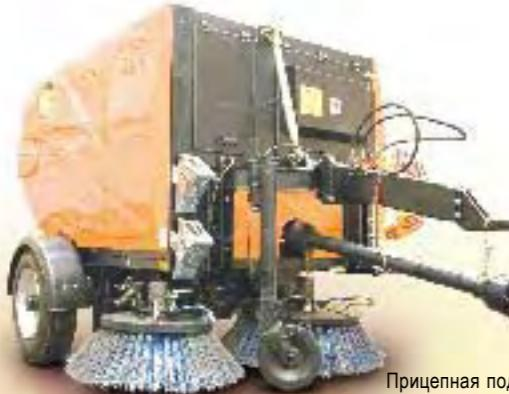
Прицепная подметальная машина ZMC 2.0 с карданным телескопическим валом
