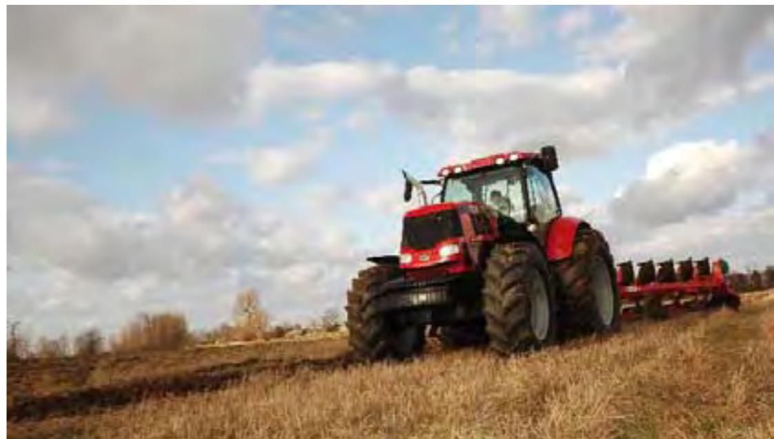
Большой интерес вызывает презентация тракторов большой мощности. На фотографии: трактор 8140 отлично справляется со вспашкой 8-пластовым обратным плугом
