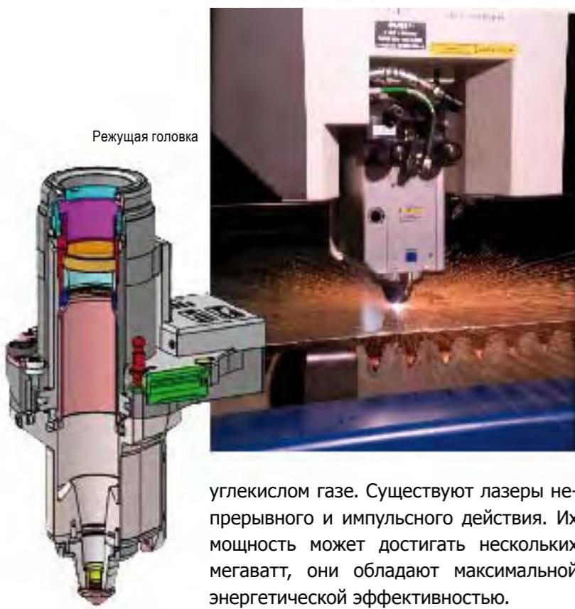
углекислом газе. Существуют лазеры непрерывного и импульсного действия. Их мощность может достигать нескольких мегаватт, они обладают максимальной энергетической эффективностью.
