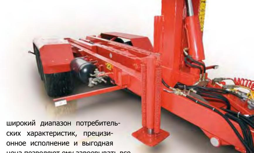
Гидравлическая опора с большой площадью основания
