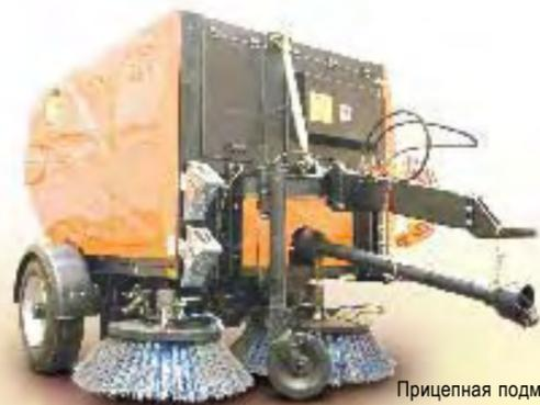
Прицепная подметальная машина ZMC 2.0 с карданным телескопическим валом
