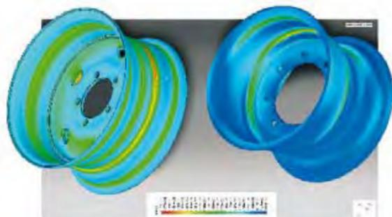
Результат испытаний колёс с помощью компьютерной системы расчётов MES. Исследования проводятся для оптимизации формы, которая повышает стойкость производимых колёс
