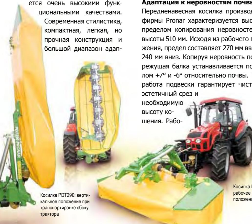
Косилка PDT 290: вертикальное положение при транспортировке сбоку от трактора
