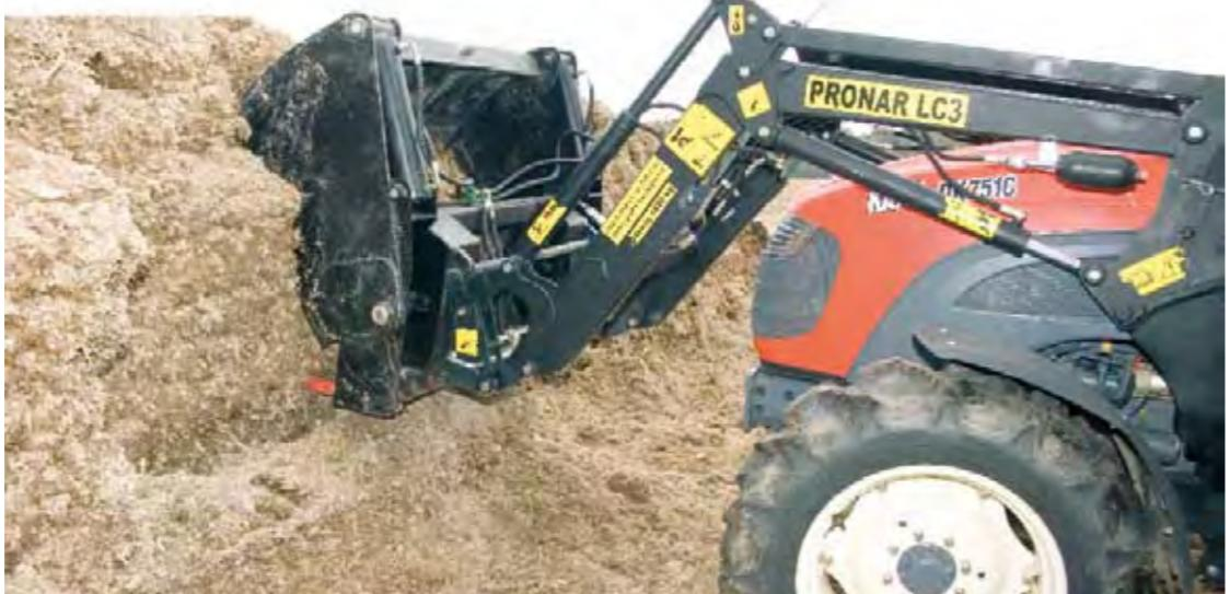
Резчик силоса, установленный на фронтальном погрузчике, позволяет вырезать блоки по всей высоте призмы силоса
