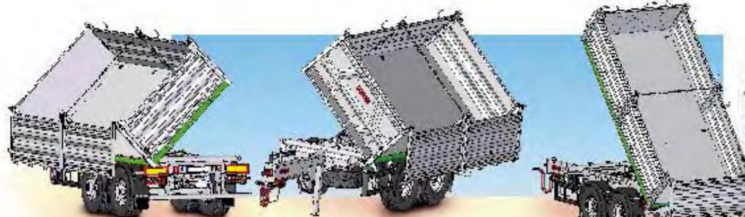
Использование гнутых профилей на бортах позволило укрепить их без приварки дополнительных укрепляющих элементов
