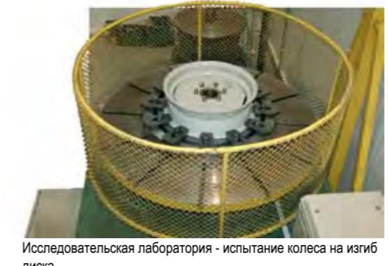
Испытательная лаборатория - испытание колеса на изгиб диска
