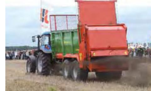
Разбрасыватель удобрений HERKULES N262 грузоподъемностью 12 тонн в действии. Участникам показа рекомендуется отойти на несколько шагов назад – ширина разброса составляет 25 метров (конечно же, с возможностью регулирования)
