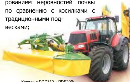
Косилки: PDD810 + PDF290: положение при транспортировке
