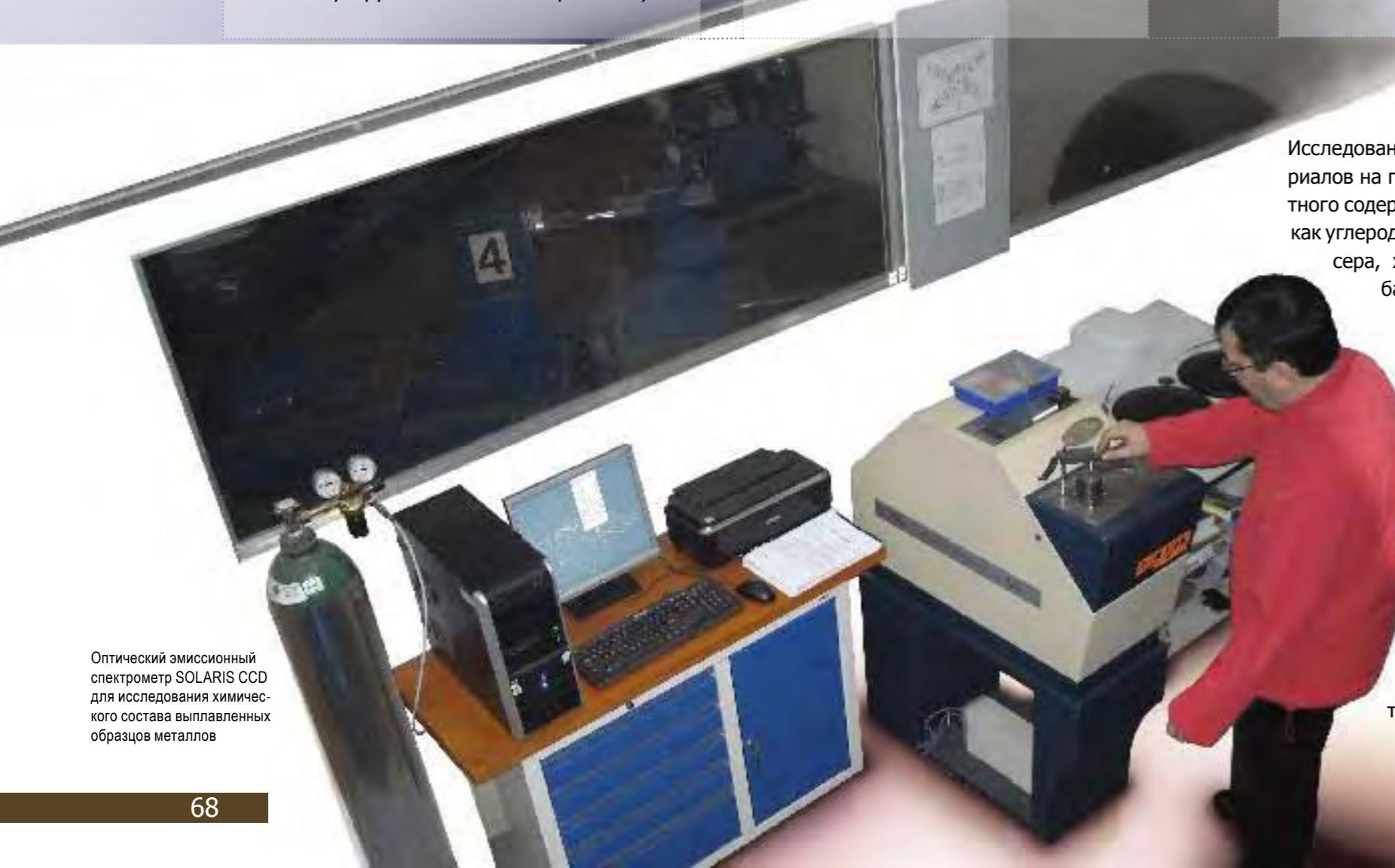
Оптический эмиссионный спектрометр SOLARIS CCD для исследования химического состава выплавленных образцов металлов
