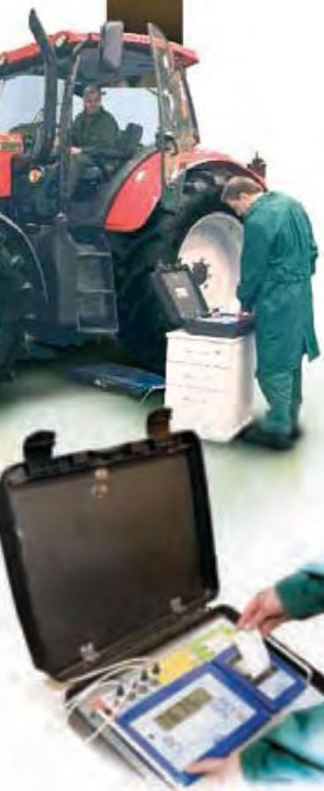
Специалисты-испытатели во время измерения нажима на почву каждого из колес трактора PRONAR P6. Трактор перед въездом на весы
