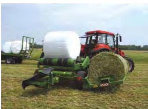
Навесной обмотчик рулона Z235 оснащен механизмом выгрузки рулона и обрезки пленки
