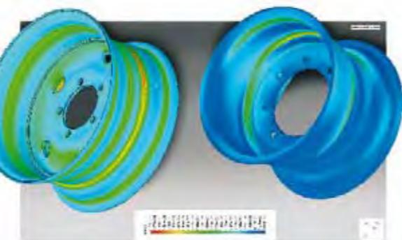
Результат испытаний колёс с помощью компьютерной системы расчётов MES. Исследования проводятся для оптимизации формы, которая повышает стойкость производимых колёс
