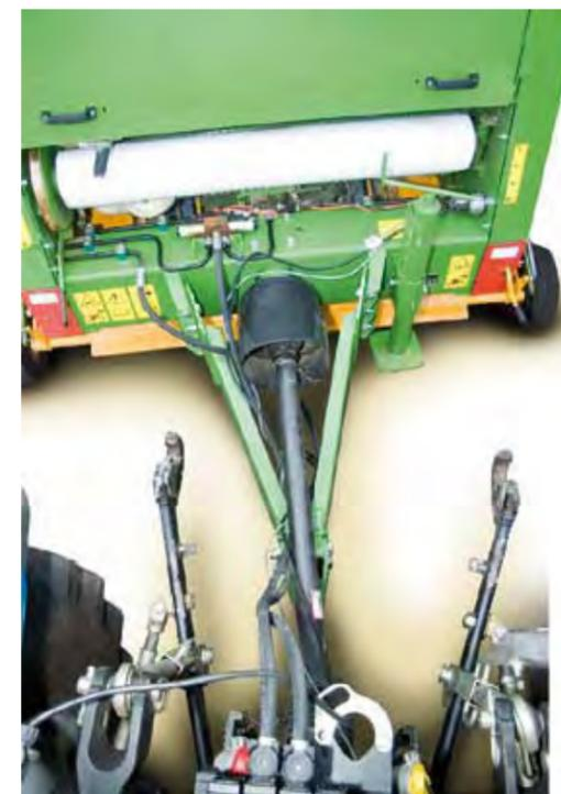
Присоединение закаточного пресс-подборщика Z 500 к трактору при помощи широкоугольного карданного телескопического вала с предохранительной муфтой
