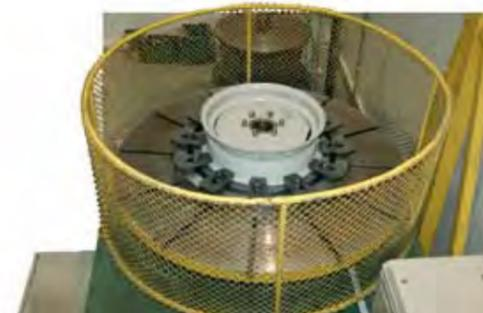
Исследовательская лаборатория - испытание колеса на изгиб диска
